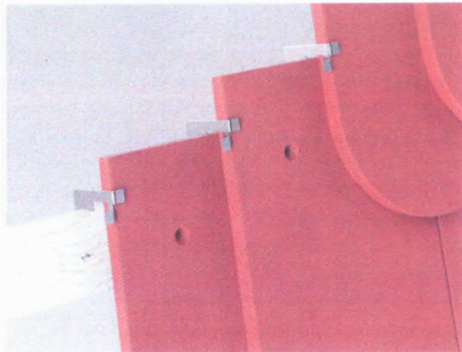
Im Gegensatz zu dem bekannten diagonalen Verlegeschema werden die neuen Biberschwanzklammern reihenweise montiert. Dadurch ergeben sich höhere Abhebewiderstände und eine einfachere Verlegung, die zusätzliche Zeiteinsparung bewirkt.
