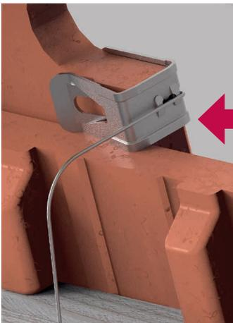
Zusätzlich kann die 513 bei fehlender Aufhängenase als „Nasenersatz“ zum Einsatz kommen. Seitlich aufgeschlagen lässt sich der Ziegel auf die Unterkonstruktion oder Lager-schicht auflegen.
