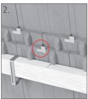
Jeden zweiten Biber der Deckschicht durch die Klammer Typ 2 mit der Lagerschicht verbinden.
