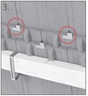
Mit der Klammer Typ 2 jeden Biber der Deckschicht mit der nächsten Lagerschicht verbinden.
