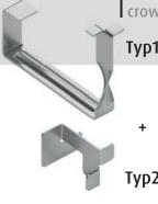
Die benötigte Klammermenge ist abhängig von der Biberanzahl, die zu sichern ist. 100 zu sichernde Biberziegel benötigen 25 Klammern Typ 1 und 75 Klammern Typ 2.
