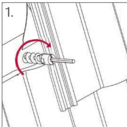
1. Mit dem Akku-Schrauber und dem beiliegenden Biteinsatz den Dübel ins Dämmelement schrauben.
