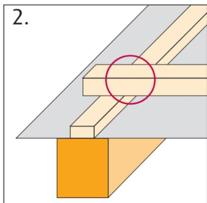
**2.** Beide Haken werden für die Schnittpunkte mit der Konterlattung verwendet.
