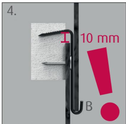
**4.** An den Auflagepunkten der Traglattung Plattenhaken B in vordere Kante der Traglattung 10 mm über der vorhandenen Schieferplatte einschlagen und Platte einstellen. Fertig.
